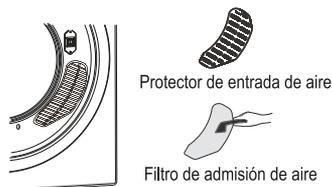
Empuje ligeramente hacia arriba con el pulgar hasta que el pestillo gancho se desconecte y, a continuación, retire.
