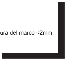
La altura del marco de la ventana es inferior a 2 mm
